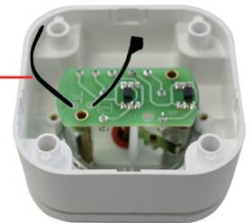
**Beachte:** Der Verdrehschutzstift der Drucktastenhalterung muss in die Bohrung auf der Platine des Schaltereinsatzes ragen.
