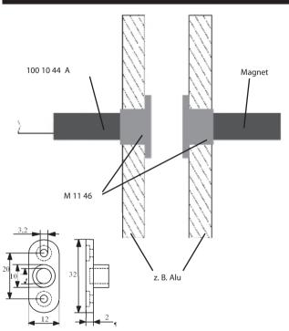
Magnetkontakt und Magnet müssen vor der Montage im Montageteil eingeklebt werden. Zur Befestigung der Einbauflansche dürfen nur Schrauben aus antimagnetischem Material verwendet werden.
